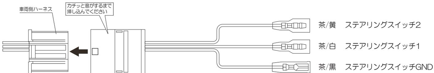
※ ステアリングスイッチの配線色はカーAVメーカーによって異なりますので、必ず取り付けるオーディオの取付説明書をご確認のうえ接続してください。
